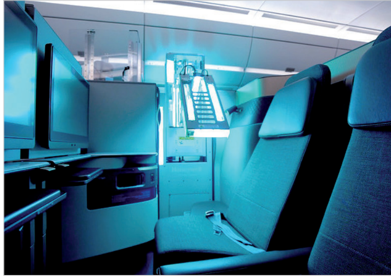
■ جهاز هانيويل لتعقيم المقصورة باستخدام الأشعة فوق البنفسجية
